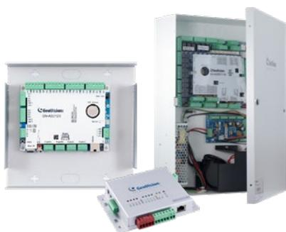
In größeren Objekten können Sie Ihr Zutrittskontroll-System modular aufbauen, mit dem Netzwerk verbinden und per Software steuern. Diese Kontroll-Einheiten gibt es auch für Fahrstühle. Die passenden Lesegeräte wählen Sie selbst.
